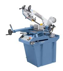
Das Modell MBS 280 DG PRO ist eine präzise Horizontalbandsäge für den universellen Einsatz. Die Merkmale dieser Maschine sind der schwenkbare Sägebügel für Doppelgehrungsschnitte von -45° bis +60°, sowie ein Hydraulikzylinder zum feinfühligen Absenken mittels Regelventil.
