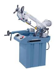
Die Horizontalbandsäge HBS 210 PRO mit schwenkbarem Sägebügel ermöglicht ein platzsparendes Arbeiten, das feinfühlige Absenken erfolgt über einen Hydraulikzylinder. Ihren Einsatzbereich findet diese hochwertige Bandsäge vorwiegend beim professionellen Anwender.
