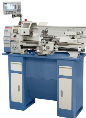
Die präzisen Leitspindeldrehmaschine Profi 550 WQV wird nach den strengen Vorgaben des DIN-Standards gefertigt. Die Besonderheit dieses Modells ist der große Längsvorschubbereich mit 6 frei wählbaren Vorschüben sowie der serienmäßige Planvorschub. Zusätzlich verfügt dieses Modell über eine elektronisch verstellbare Drehzahlregelung sowie einer 2-Achs-Positionsanzeige.
