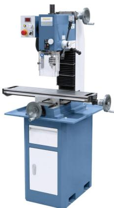
Die Bohr- und Fräsmaschine BF 28 L Vario ist bereits in der Grundausstattung mit einer digitalen Drehzahl- und Pinolenhubanzeige ausgestattet. Ihren Einsatzbereich findet diese Maschine beim professionellen Anwender, im Modellbau und im Ausbildungsbereich.
