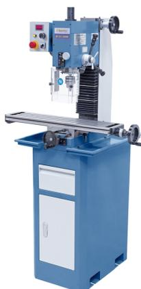
Die Bohr- und Fräsmaschinen BF 22 L Vario ist bereits in der Grundausstattung mit einer digitalen Drehzahl- und Pinolenhubanzeige ausgestattet. Ihren Einsatzbereich findet diese Maschine beim professionellen Anwender, im Modellbau und im Ausbildungsbereich.
