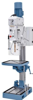
Das Modell GB 40 S Vario ist eine schwere Getriebebohrmaschine mit stufenloser Drehzahlregelung, automatischem Pinolenvorschub und digitaler Drehzahlanzeige. Ihren Einsatzbereich findet dieses Modell hauptsächlich in Reparaturbetrieben und im Maschinenbau.
