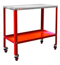
Der fahrbarer Schweißtisch von Holzmann bietet eine praktische Lösung für Schweißarbeiten. Mit einer Beladungskapazität von bis zu 540 kg und einem einfachen Zusammenbau ist er ideal für den Einsatz in der Werkstatt oder auf der Baustelle. Durch die 4 schwenkbaren Räder kann der Tisch leicht rangiert werden, und die Bremsen an allen 4 Rädern sorgen für Stabilität.
