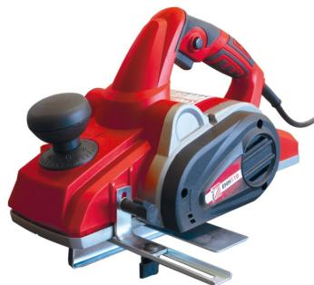
Der HOLZMANN EHH110\_230V ist das ideale Gerät für schnelle Hobelarbeiten, die keine stationäre Hobelmaschine erfordern. Handlich und kompakt ist er dennoch sehr vielseitig und kann sowohl als Hand- als auch als Abrichthobelmaschine eingesetzt werden. Mit der V-Nutführung am Aufnahmetisch können Anfasungen vorgenommen werden, mit dem mitgelieferten Tiefenanschlag sind sogar Stufen/Falzschnitte möglich.
