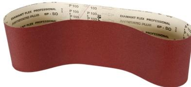
Das Schleifband SBM100LK40 (Körnung 40) ist passend für Metallschleifmaschinen MSM100NEO und MSM100L (nicht mehr im Programm). Es handelt sich um ein schweres Baumwollgewebe mit Vollkunstharzbindung und Aluminiumoxidkorn. Die Abmessungen betragen 100 mm Breite und 1220 mm Länge.
