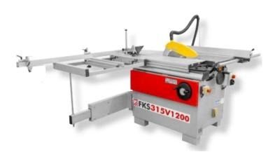
Die Holzmann FKS315V1200\_400V Formatkreissäge ist ideal für die Bearbeitung von Werkstücken und das Zuschneiden von Platten. Sie verfügt über einen Alu-Formatschiebetisch und einen Auslegertisch, sowie einen zentralen Bedienpunkt an der Maschine. Die Sägeblatthöhenund -winkelverstellung erfolgt mittels Handrad und eine analoge Winkelanzeige ermöglicht das Ablesen der Sägeblattneigung.
