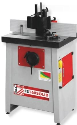
Tischfräsmaschine mit massivem, verwindungsfreiem Graugusstisch
