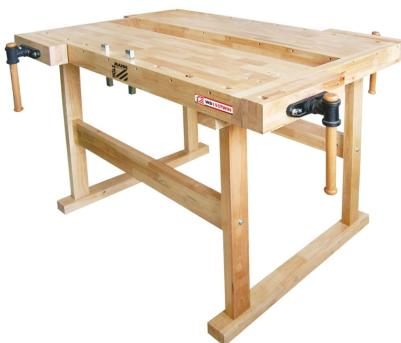
Die Holzmann WB155TWIN Werkbank ist ideal für Hobby- und Profiwerkstätten sowie für Ausbildungszwecke. Zwei Personen können gleichzeitig arbeiten. Die Arbeitsfläche besteht aus Gummibaumholz und verfügt über vier Hobelbankzangen, einen Stauraum mit Ablagefächern und zwei Metallbankhaken.
