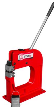
Das Holzmann STST16 Stauch- und Streckgerät ist universell einsetzbar zum Stauchen und Strecken von diversen Blechen bis 1,5 mm. Es bietet eine einfache Bedienung zur schnellen Bearbeitung und ist inklusive Stauch- und Streckwerkzeug zum Austauschen. Die Ausladung beträgt 208 mm.
