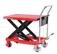
Der Holzmann SHT300XF Scheren-Hubtischwagen bietet eine einfache und ergonomische Lösung für das Heben und Senken von Arbeitsmaterial. Durch das Fußpedal kann der Arbeitstisch auf eine individuelle Arbeitshöhe gehoben werden. Das stufenlose Absenken des Arbeitstisches erfolgt mittels Handhebel. Zusätzlich verfügt der Wagen über eine Feststellbremse und Transportgriffe sowie zwei Lenkräder für einfaches Rangieren.
