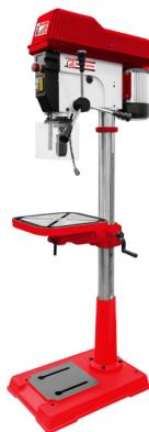
Die Holzmann SB163VH\_230V Ständerbohrmaschine ist eine leistungsstarke Maschine für das Bohren und Fräsen von Holz und Metall. Sie verfügt über eine variable Drehzahleinstellung mit LCD-Anzeige, LED-Licht und eine solide Grundplatte für gute Standsicherheit. Die Maschine hat eine biegesteife Bohrsäule mit geschliffener Oberfläche und einen neigbaren Bohrtisch, der über eine Zahnstange höhenverstellbar ist.
