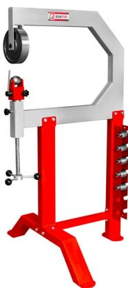
Die Holzmann RSM710 Rollenstreckmaschine ist eine kompakte und günstige Lösung für die Blechbearbeitung. Sie verfügt über einen geschweißten Stahlrahmen und ist inklusive 6 wechselbarer Räder. Die Radien des unteren Rades betragen 2", 3", 4", 6", 8" und 12", während das obere Rad eine Maß von 8" x 2" hat.
