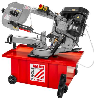
Die Holzmann BS712TURN\_230V Metallbandsäge ist eine platzsparende Maschine aufgrund ihres Fahrwerks. Sie verfügt über eine automatische Endabschaltung und eine solide Gussmaschine mit kugelgelagerter Sägebandführung. Weitere Ausstattungsmerkmale sind ein Späneabscheider, eine Schmiermittelpumpe, ein schwenkbarer Profischraubstock und ein Werkstückanschlag. Die Senkgeschwindigkeit des Sägearms ist über einen Hydraulikzylinder stufenlos einstellbar.
