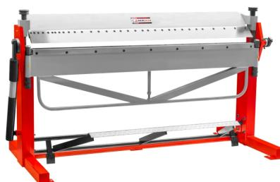
Die Holzmann AKM2020 Abkantmaschine bietet eine solide Konstruktion mit hochwertigen Abkantelementen für ein Höchstmaß an Präzision. Durch das einfache Öffnen der oberen Wange via Fußpedal und die verschiedenen breiten Abkantelemente für unterschiedliche Werkstückgrößen, bietet diese Maschine eine hohe Flexibilität. Die Abkantelemente sind beliebig verschieb- und zusammensetzbare, und die Blechdicke kann einfach über groß dimensionierte Justierschrauben eingestellt werden.
