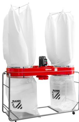
Die Holzmann ABS8000PRO\_400V Absauganlage ist eine leistungsstarke Lösung für die Absaugung von Staub und Spänen. Sie verfügt über eine solide Blechkonstruktion, die ideale Strömungsverhältnisse ermöglicht, und ein widerstandsfähiges Windflügelrad aus Stahl. Die Anlage bietet eine konstante Absaugleistung auch bei dauernder Beanspruchung und kann bis zu vier Maschinen durch den mitgelieferten Verteiler anschlussfähig sein.
