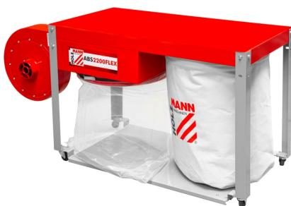
Die Holzmann ABS2200FLEX\_400V Absauganlage für Säge ist eine leistungsstarke Lösung für die Holzbearbeitung. Mit ihrer soliden Blechkonstruktion und dem widerstandsfähigen Windflügelrad bietet sie eine konstante Absaugleistung auch bei dauernder Beanspruchung. Die integrierte Fahrleinrichtung ermöglicht ein einfaches Rangieren.
