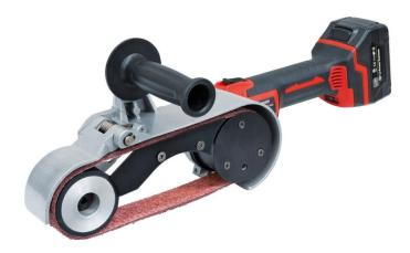
Die Bernardo TBS 620 A Rohrschleifmaschinen sind ideal für das Verschleifen von Schweißnähten auf Rohren. Durch den beweglichen Schwenkarm passt sich das Schleifband dem jeweiligen Rohrdurchmesser an. Die große Kontaktrolle ermöglicht ein Verschleifen von Schweißnähten auf planen Flächen ohne Verkanten oder Wellenbildung.
