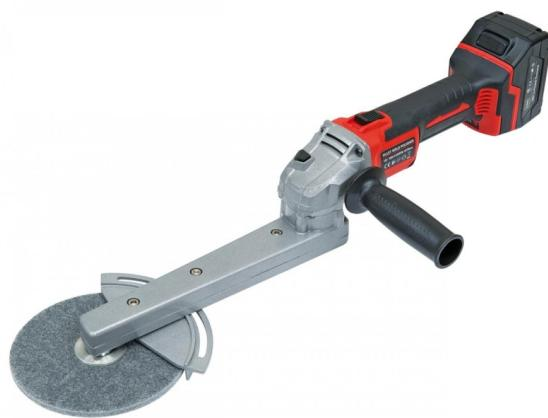
Die Bernardo KNS 150 A Kehlnaht-Schleifmaschine ist optimal geeignet zum Bearbeiten von Schweißnähten an schwer zugänglichen Stellen. Der Zusatzgriff kann um 180° gedreht werden, ideal für eingeschränkte Platzverhältnisse. Die Maschine ist konzipiert zum Schleifen und Polieren von Edelstahlkonstruktionen und geeignet für Schleif- und Polierscheiben bis max. 150 mm Durchmesser.
