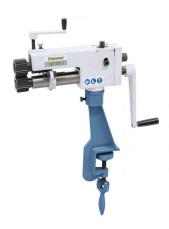
Die Bernardo SM 180 S Manuelle Sickenmaschinen sind ideal für das Herstellen von Aussteifungs- und Verbindungssicken. Sie bieten eine schnelle und einfache Montage an Werkbänken mittels drehbarem Montagefuß und eine stabile Gusskonstruktion in moderner Ausführung.
