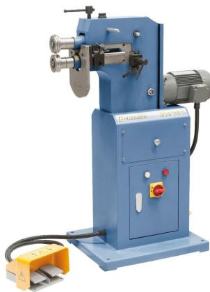
Die Bernardo MSM 300 C Motorische Sickenmaschinen sind ideal für das wirtschaftliche Herstellen verschiedenster Sickenarten. Durch 8 verschiedene, optional erhältliche Walzenpaare, erweitert sich der Einsatzbereich dieser Maschinen. Die obere Welle mit Schnellverstellung und stabiler Klemmung sowie die axial verschiebbare Anschlagplatte für hohe Wiederholgenauigkeit, ermöglichen präzise Arbeiten.
