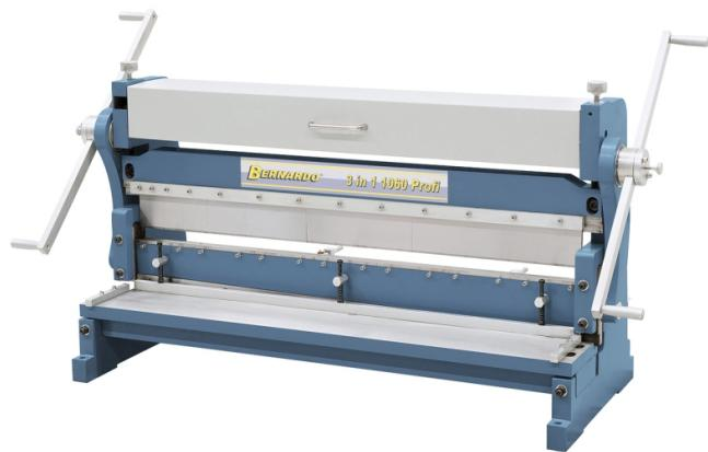
Die Bernardo 3 in 1 - 1060 Profi Universalmaschinen sind zum Rundbiegen, Abkanten und Schneiden geeignet. Sie sind ideal für Karosseriebauer, Modellbauer und den Baustelleneinsatz. Die Maschinen verfügen über eine hohe Oberwange zum Herstellen von hoch aufgekanteten Profilen und einen geschliffenen Messerbalken aus hochwertigem Stahl.
