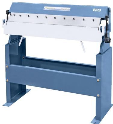
Die Bernardo SB 915 S Schwenkbiegemaschinen mit segmentierter Oberwange ist eine manuelle Biegemaschine für Standardaufgaben. Sie bietet eine schwenkbare Biegewange über Bügelgriff und eine Oberwangenschiene mit Spitzenwinkel 45°. Das preiswerte Einsteigermodell für den Handwerker ermöglicht eine bedienungsfreundliche Oberwangenzustellung über Exzenter. Die herausnehmbaren Segmente ermöglichen das Biegen von Schachteln und die spezielle Klemmvorrichtung sorgt für sicheres Klemmen des Bleches.
