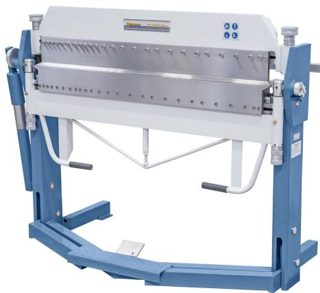
Die Bernardo TB 1270 Flex Schwenkbiegemaschinen mit segm, Ober-, Unter- und Biegewange ist eine universell einsetzbare Biegemaschine für Spenglereien und Reparaturbetriebe. Durch Klaviereinsätze in der Ober-, Unter- und Biegewange ergibt sich eine große Anzahl von Biegemöglichkeiten. Kassetten und Spezialprofile mit entgegengesetzten Biegungen sind mit diesen Modellen leicht durchführbar.
