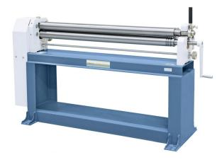
Die Bernardo RM 1300 x 1,5 Pro Manuelle Rundbiegemaschinen bieten ein optimales Preis-Leistungsverhältnis und sind serienmäßig mit Untergestell ausgestattet. Durch die asymmetrische Walzenanordnung ermöglichen sie ein bequemes Vorbiegen. Die Biegewalzen sind aus hochwertigem Stahl gefertigt und die Walzenantrieb erfolgt über ein massives Zahnradgetriebe. Die Maschinen sind zum Herstellen von Kegeln, Rohren, Zylindern usw. geeignet.
