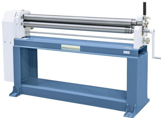
Die Bernardo RM 1300 x 1,5 Pro Manuelle Rundbiegemaschinen sind ideal für das Herstellen von Kegeln, Rohren, Zylindern und anderen runden Werkstücken. Durch die asymmetrische Walzenanordnung kann das Vorbiegen bequem durchgeführt werden. Die Biegewalzen sind aus hochwertigem Stahl gefertigt.
