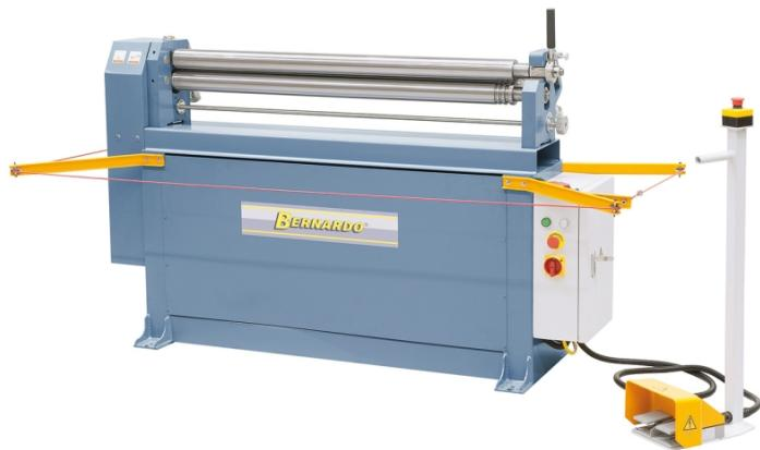
Die Bernardo ESR 1300 x 1,6 Pro Motorische Rundbiegemaschinen sind ideal für das Einrollen von Stahl, Blech, Edelstahl und Aluminium. Sie sind serienmäßig mit separatem Fußpedal mit Not-Aus-Funktion und Biegewalzen aus hochwertigem Stahl gefertigt. Die Maschinen sind zum Herstellen von Kegeln, Rohren, Zylinder usw. geeignet.
