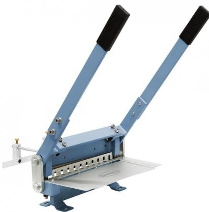
Der Bernardo HS 300 x 1,5 Handscheren ist ideal für das schnelle und rationelle Schneiden verschiedenster Materialien bis 1,5 mm Stärke. Der Hinteranschlag mit Skala ist im Lieferumfang enthalten. Durch das geringe Eigengewicht ist der Handscheren ideal für den mobilen Einsatz. Die vordere Blechauflage verfügt über eine mm-Skala für exaktes Arbeiten. Das Messer besteht aus Werkzeugstahl, ist gehärtet und geschliffen.
