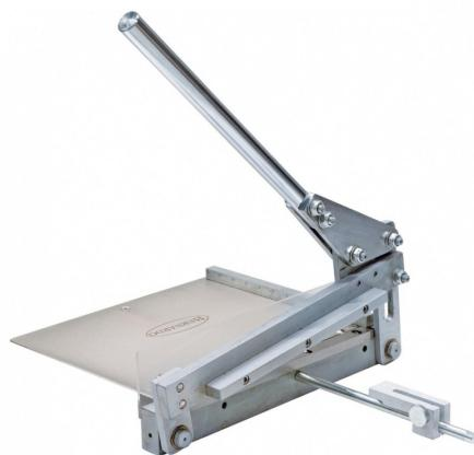
**Bernardo BHS 300 x 1,2 Handtafelscheren** sind zum Schneiden verschiedenster Materialien, wie z.B. Stahlblech, Messing, Aluminium, Kupfer, ... geeignet. Die Tafelblechscheren verfügen über einen Hinteranschlag mit Skala und einen rechtwinkeligen Anschlag mit mm-Skala auf dem Scherentisch. Ober- und Untermesser aus Qualitätsstahl garantieren ein sauberes und grätfreies Schneiden.
