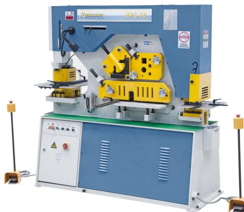
Die Bernardo HPS 90 Hydraulische Profilstahlscheren ist ein leistungsstarkes Werkzeug für die Metallverarbeitung. Die Maschine verfügt über eine Stanzenkraft von 90 Tonnen und eine maximale Stanzleistung von 20 mm. Die Durchmesser x Stärke beträgt 30 mm und die Hublänge 80 mm. Die Hubzahl bei 20 mm Hub beträgt 6 cpm.
