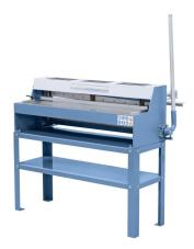
Die Bernardo PTS 1050 S Handtafelscheren sind ideal für präzise Schnitte in verschiedenen Materialien. Die Maschine bietet eine Schnittlänge von 1050 mm und kann Bleche mit einer Maximalstärke von 1,0 mm schneiden. Der Schnittwinkel beträgt 3°, und der Hinteranschlag kann zwischen 0 und 500 mm eingestellt werden. Die Seitenanschlag ist 240 mm lang. Die Maschinenabmessungen betragen 1320 x 990 x 940 mm, und das Gewicht beträgt etwa 160 kg.
