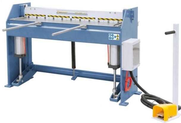
Die Bernardo PTS 1270 x 1,2 Pneumatische Tafelschere ist ein leistungsstarkes Werkzeug zum Schneiden verschiedenster Materialien, wie z.B. Stahlblech, Messing, Aluminium, Kupfer usw. Durch die zweischneidigen Ober- und Untermesser aus Qualitätsstahl wird ein sauberes und grätfreies Schneiden gewährleistet. Die Bedienung erfolgt mittels Fußpedal, wodurch die Hände frei bleiben, um das Blech optimal zu positionieren.
