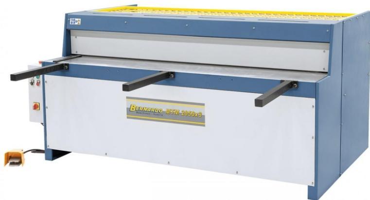
Die Bernardo MTM 1250 x 3 mm Motorische Tafelscheren ist ideal für rationelles Schneiden verschiedenster Materialien, wie z.B. Stahlblech, Messing, Aluminium, Kupfer usw. Durch die zweischneidigen Ober- und Untermesser aus Qualitätsstahl wird ein sauberes und grätfreies Schneiden garantiert.
