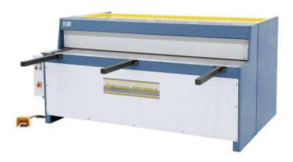
Die Bernardo MTM 1250 x 3 mm Motorische Tafelscheren ist ein leistungsstarkes Werkzeug für die Metallverarbeitung. Mit einer Schnittlänge von 1250 mm und einer maximalen Blechstärke von 3 mm ist sie ideal für den Einsatz in der Industrie und im Handwerk.
