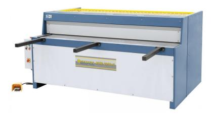
Die Bernardo MTM 2050 x 3 mm Motorische Tafelscheren ist eine leistungsstarke Maschine für die Metallverarbeitung. Mit einer Schnittlänge von 2050 mm und einer maximalen Blechstärke von 3 mm ist sie ideal für verschiedene Anwendungen. Die Maschine verfügt über eine Motorleistung von 4,0 kW und eine Arbeitshöhe von 820 mm.
