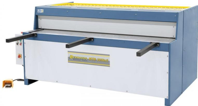
Die Bernardo MTM 2050 x 3 mm Motorische Tafelscheren ist ideal für rationelles Schneiden verschiedenster Materialien, wie z.B. Stahlblech, Messing, Aluminium, Kupfer usw. Durch zweischneidige Ober- und Untermesser aus Qualitätsstahl wird ein sauberes und gratfreies Schneiden garantiert.
