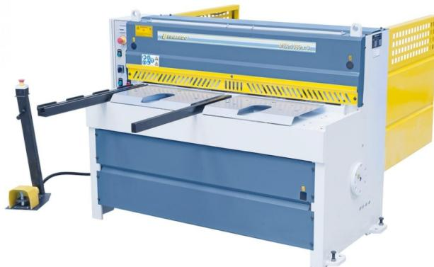
Die Bernardo MTA 1560 x 3 Motorische Tafelscheren ist ideal für rationelles Schneiden verschiedenster Materialien. Der präzise Hinteranschlag kann schnell mittels Handrad verstellt werden. Die Maschine verfügt über eine Schutzabdeckung und Fotozellen an der Rückseite für hohe Bediener Sicherheit.
