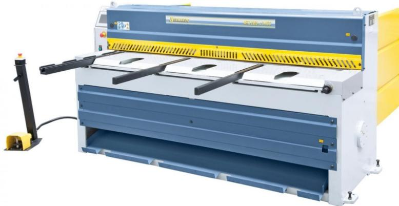
Die Bernardo MTR 2060 x 3 NCC Motorische Tafelscheren sind ideal für das Schneiden verschiedenster Materialien, wie z.B. Stahlblech, Messing, Aluminium, Kupfer usw. Die Maschine verfügt über eine Steuerung Fuji mit Touchscreen und einen motorischen NC-Hinteranschlag für erhöhte Sicherheit.
