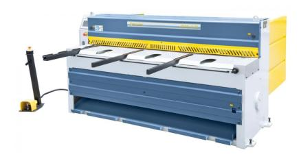
Die Bernardo MTR 3060 x 2 NCC Motorische Tafelscheren ist eine leistungsstarke Maschine für die Metallverarbeitung. Mit einer Schnittlänge von 3060 mm und einer Maximalen Blechstärke von 2 mm ist sie ideal für verschiedene Anwendungen. Die Maschine verfügt über eine Motorleistung von 4,0 kW und eine Arbeitshöhe von 830 mm.
