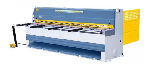
Die Bernardo MTR 3060 x 4 NCC Motorische Tafelscheren ist eine leistungsstarke Maschine für die Metallverarbeitung. Sie bietet eine Schnittlänge von 3060 mm und eine maximale Blechstärke von 4 mm. Die Maschine hat eine Arbeitshöhe von 800 mm und einen Hinteranschlag von 0 - 750 mm. Die Tischbreite beträgt 450 mm und die Motorleistung 7,5 kW.
