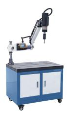
Die Bernardo TM 36 E / R 1200 Gewindeschneidmaschinen sind für präzise Gewindebohrungen konzipiert. Mit einer Drehzahl von 30 - 150 U/min und einem verstellbaren Winkel von  $0^{\circ}$  -  $90^{\circ}$  können verschiedene Arbeiten durchgeführt werden. Der maximale Arbeitsradius beträgt R 1200 mm.
