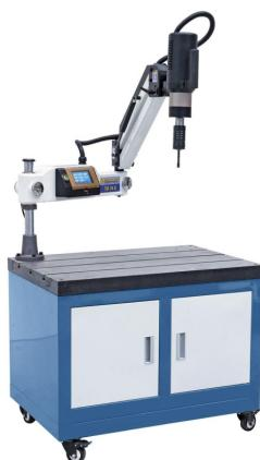
Die Bernardo TM 36 E / R 1200 Gewindeschneidmaschinen sind für das Gewindeschneiden in Stahl, Edelstahl, Aluminium und Buntmetalle konzipiert. Durch die Schwenkbare Motoreinheit können Gewinde in jedem gewünschtem Winkel zwischen 0° und 90° geschnitten werden. Die Maschinen bieten höhere Genauigkeit im Vergleich zum manuellen Gewindeschneiden und garantieren rechtwinklige Gewinde.
