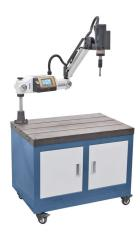
Die Bernardo TM 12 E / R 1100 Gewindeschneidmaschinen sind für präzise Gewindebohrungen konzipiert. Die Maschinen bieten eine flexible Verstellbarkeit und sind für verschiedene Anwendungen geeignet.
