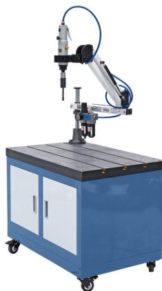
Die Bernardo TM 16 P / R 1000 Gewindeschneidmaschinen bieten hohe Produktivität und deutliche Zeitsparnis gegenüber dem manuellen Gewindeschneiden. Durch ihre höhere Genauigkeit im Vergleich zum manuellen Gewindeschneiden ist das Gewinde garantiert rechtwinkelig (90°). Die Maschinen sind inklusive Schwenkarm mit großem Radius für einfaches Positionieren des Gewindebohrers am Werkstück und schwenkbare Motoreinheit zum Gewindeschneiden in jedem gewünschtem Winkel zwischen 0° und 90°.
