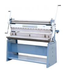
Die Bernardo 3 in 1 - 1320 S Universalmaschinen sind ideal für Karosseriebauer, Modellbauer und Baustelleneinsatz. Sie ermöglichen das Rundbiegen, Abkanten und Schneiden von Materialien.
