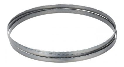
Das Bernardo Sägeband 2950 x  $16 \times 0.6 \text{ mm}$  ist ein hochwertiges Sägebänder für Holzbandsägen. Es ist 2950 mm lang, 16 mm breit und 0.6 mm stark.
