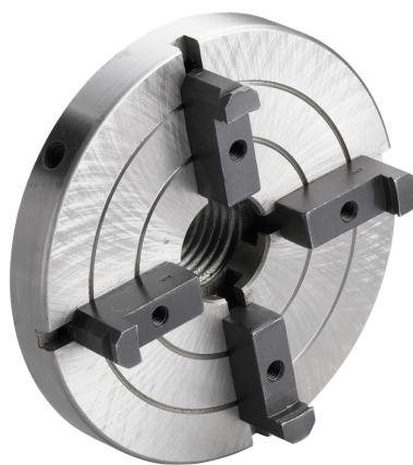
4-Backen-Planscheibe 150 mm mit Gewinde M33
