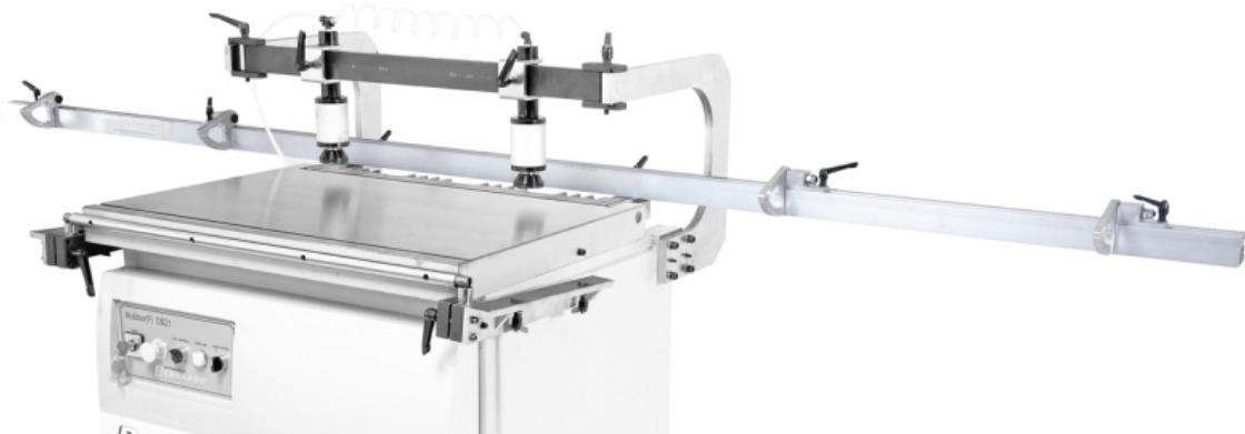
Der Bernardo Alu-Anschlag 3000 mm mit 4 Anschlagklappen ist für DB 21 Zubehör Dübelbohrmaschinen konzipiert. Dieser Anschlag bietet eine zuverlässige und präzise Führung für Ihre Bohrarbeiten.
