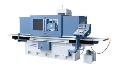
Die Bernardo BSG 60160 PLC Flachschleifmaschine ist eine professionelle Maschine für die Bearbeitung von Flächen. Die Maschine verfügt über eine Tischaufspannfläche von 600 x 1600 mm und eine Elektro-Magnetspannplatte von 600 x 800 mm. Die maximale Verfahrweglänge beträgt 1750 mm und die maximale Verfahrwegbreite 660 mm.
