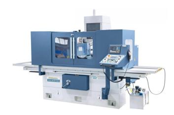
Diese Modelle eignen sich für die Bearbeitung von Werkstücken bis 900 kg und einer Schleiffläche bis 1700 x 560 mm. Durch die umfangreiche Serienausstattung wie z.B.: Computergesteuerte Vertikalzustellung, Parallelabziehvorrichtung mit Mikrometerverstellung, Magnetplatte mit Entmagnetisierungseinrichtung sowie der 2-Achs-Digitalanzeige bieten diese Modelle ein optimales Leistungspaket für den Anwender.
