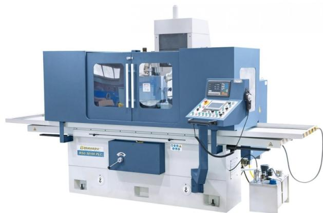
Diese Modelle eignen sich für die Bearbeitung von Werkstücken bis 900 kg und einer Schleiffläche bis 1700 x 560 mm. Durch die umfangreiche Serienausstattung wie z.B.: Computergesteuerte Vertikalzustellung, Parallelabziehvorrang mit Mikrometerverstellung, Magnetplatte mit Entmagnetisierungseinrichtung sowie der 2-Achs-Digitalanzeige bieten diese Modelle ein optimales Leistungspaket für den Anwender.
