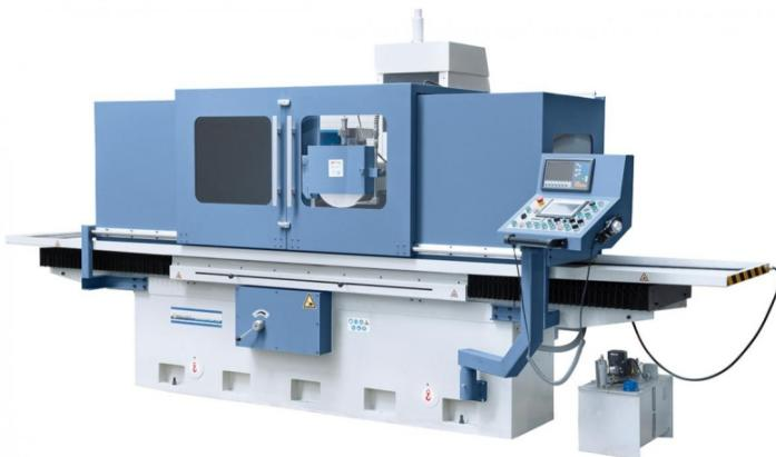
Die Bernardo BSG 60120 PLC Flachschleifmaschinen sind für präzise und effiziente Bearbeitung von Werkstücken konzipiert. Die Maschinen verfügen über eine gehärtete und geschliffene Tischführungsfläche sowie Turcite-B beschichtete Gegenführungen für hohe Verschleißfestigkeit und geringe Reibung. Die Tischlängs- und Querbewegung erfolgt über eine V-Flachführung, und die computergesteuerte Zustellung mittels Eilgang auf die Werkstückhöhe ermöglicht einstellbare Schlicht- und Auffeuerhübe.
